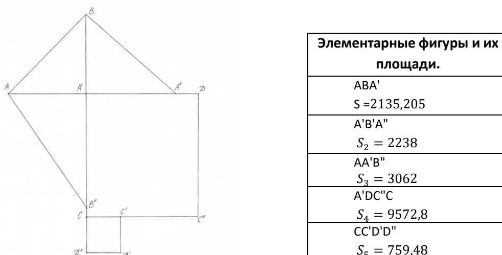
Рис. 2. Аппроксимация водного зеркала Ладожского озера элементарными фигурами с расчетом их площадей
